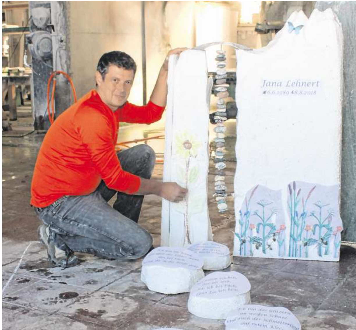
So sehen die Entwürfe von Steinmetz Herbert Baldauf aus. Er fertigt ein Modell aus Styropor, auf das er Symbole einarbeitet, die an einen Verstorbenen erinnern. Erst danach setzt er seine Entwürfe auf dem Grabstein um. Foto: Kempf
